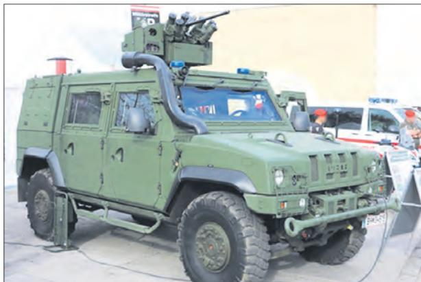
*На вооружении военной полиции состоят тактические бронированные автомобили «Ивеко» LMV с дистанционно управляемым модулем вооружения*
