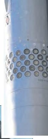
Газодинамический пояс двигателей поперечного управления (моментного действия), размещенный впереди центра массы и аэродинамического фокуса реактивного снаряда «Ольха-М»
