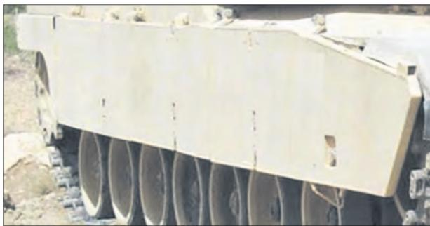
*Экран бортового бронирования танка M1A1 SEP «Абрамс»*
